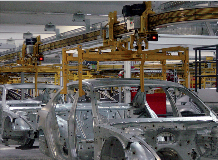
Elektrohängebahnen mit Karosserien in der Automobilindustrie
